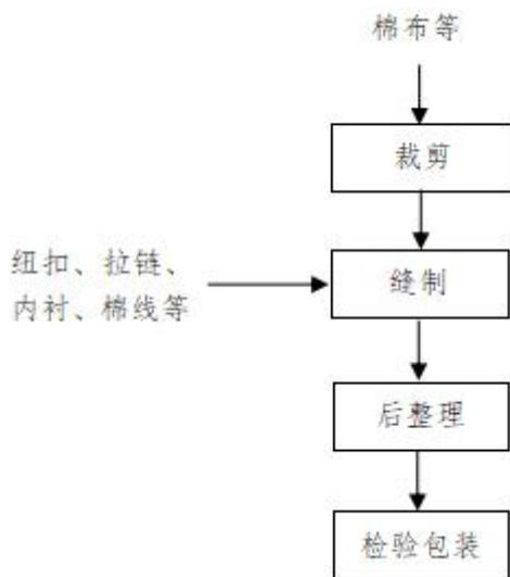
图 3 生产工艺流程图
